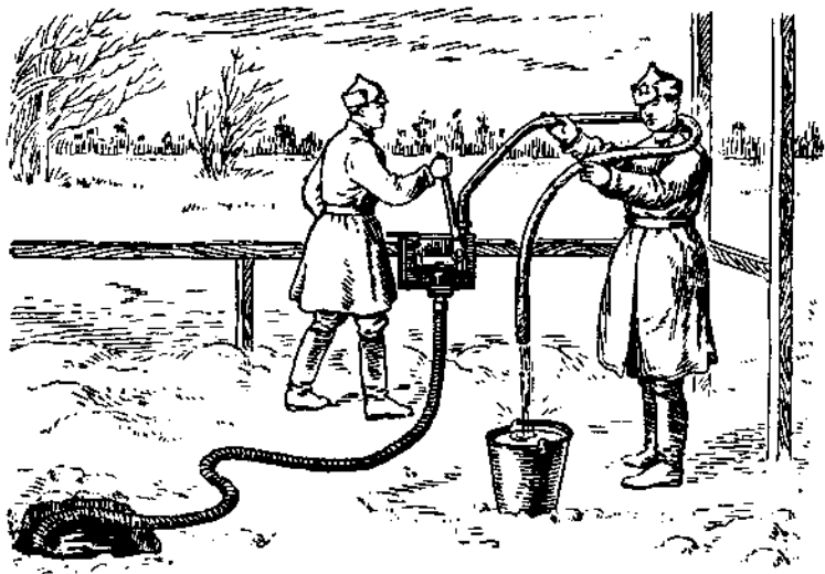
Рис. 7. Насос, установленный на перекладине.
